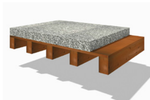
Утепление чердачных перекрытий
