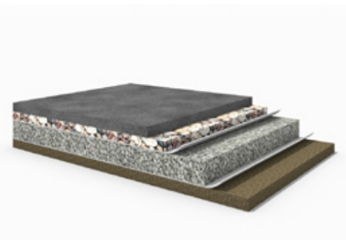
Нижний слой конструкции автомобильных дорог
